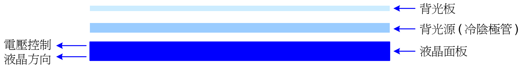
圖5.2 液晶電視發光原理與基本構造
