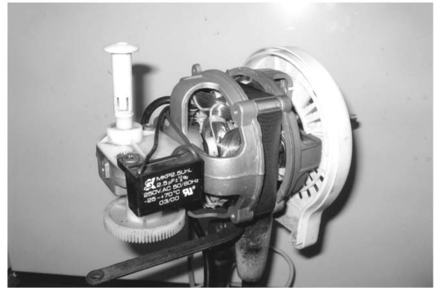
圖5.9 交流馬達的電路圖 (a) 及風扇馬達 (b)，請注意馬達內的線圈及後方黑色的電容。
